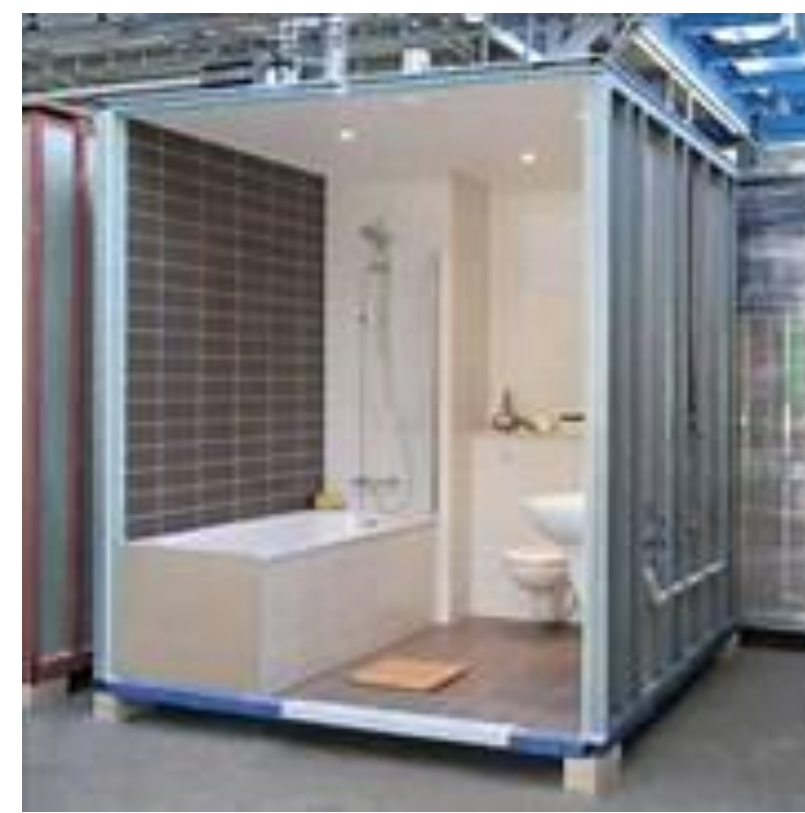
Cat 5a 3D Volumetric subassembly (Pod)
